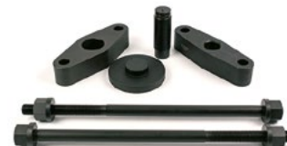
67223401 Съемник шкворней для SCANIA
