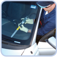
Снятие лобового стекла и других стекел
