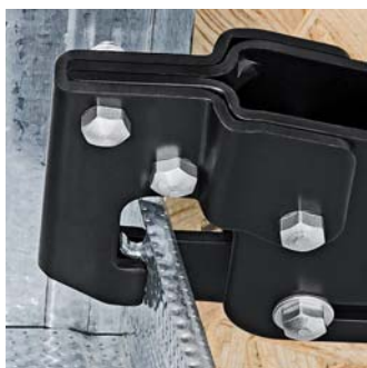
Установка инструмента на оба соединяемых профиля
