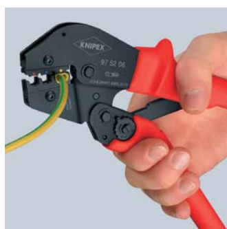
Второй этап: сжать ручки для продолжения процесса опрессовки
