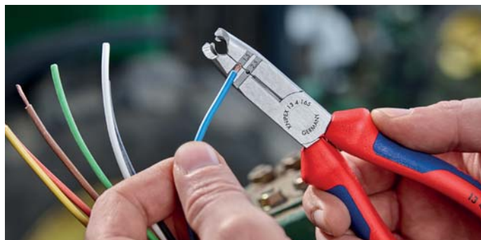
С отверстиями для удаления изоляции с проводов 1,5 и 2,5 мм 2
