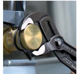
Плоскогубцы захватные (плоскогубцы, длинногубцы, клещи сантехнические и т.д.)
