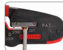
Зачистка круглого провода
