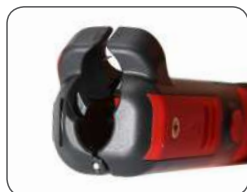
Лезвие для продольного разреза оболочки
