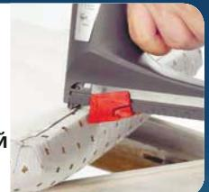
Дистанционный упор применяется при работах, требующих исключительно параллельного расположения скоб.
