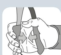
5. Сдавить рукоятки. Повторять процесс до тех пор, пока не оторвется оправка заклепки.
