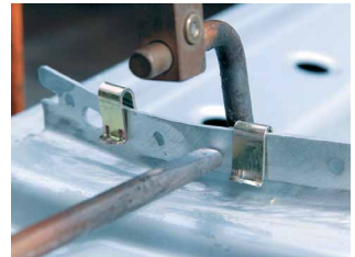
3. Мощная скоба неподвижно фиксирует листовый материал в заданном месте. Чтобы удалить зажим, вставьте клещи в отверстия скобы и раскройте их.
